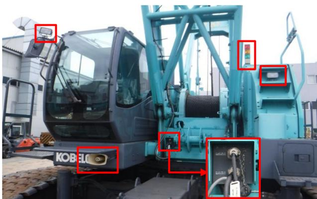
機械本体に付属している機器（ライト、ホーン、メタコン、作業灯、カメラ等）は、防水加工が施されているものもありますが、直接高圧洗浄すると水が浸入する恐れがありますので、距離を空けて洗浄を行ってください。また、塗装面に傷やひび割れがある部分に、直接高圧洗浄すると塗装が剥がれる恐れがあります。再塗装を行った上で、距離を空けて洗浄を行ってください。
