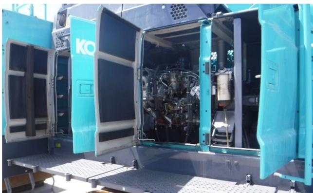
エンジンや電装品が配置されているガード内には直接高圧洗浄しないようご注意ください。また、洗浄時にマフに水が浸入しないよう養生を行い、洗浄後は養生が除去されていることを必ずご確認ください。
