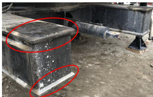
アクスル（クローラフレーム挿入部）や油圧シリンダのロッド部は油膜によって摩耗や錆を防止しています。洗浄後は水分が無い状態にし、再度グリスアップ（油圧シリンダーのロッド部には作動油の塗布）を行ってください。
