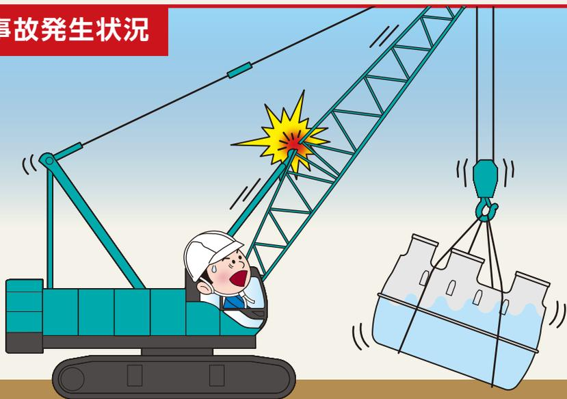
水タンク(タンク重量約6ton/水の重量は不明)を吊り上げ作業中に水タンクが傾き、ブームがねじれるように折損した。
