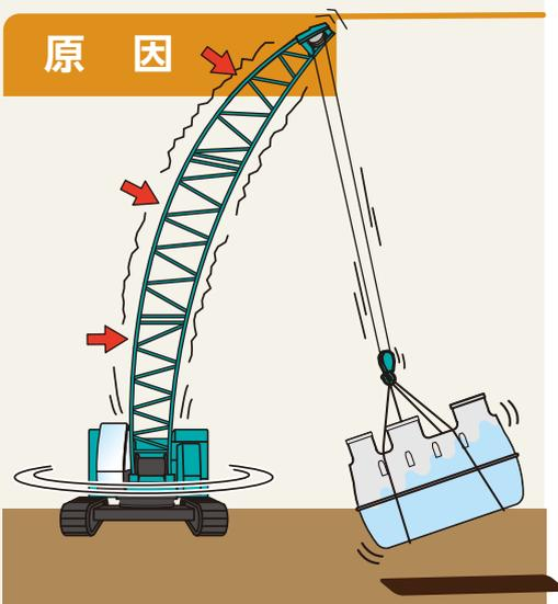
旋回停止時、水タンク内の水が揺れ、重心位置が移動したことによりブームにねじれ荷重がかかり、折損(座屈)に至った。
