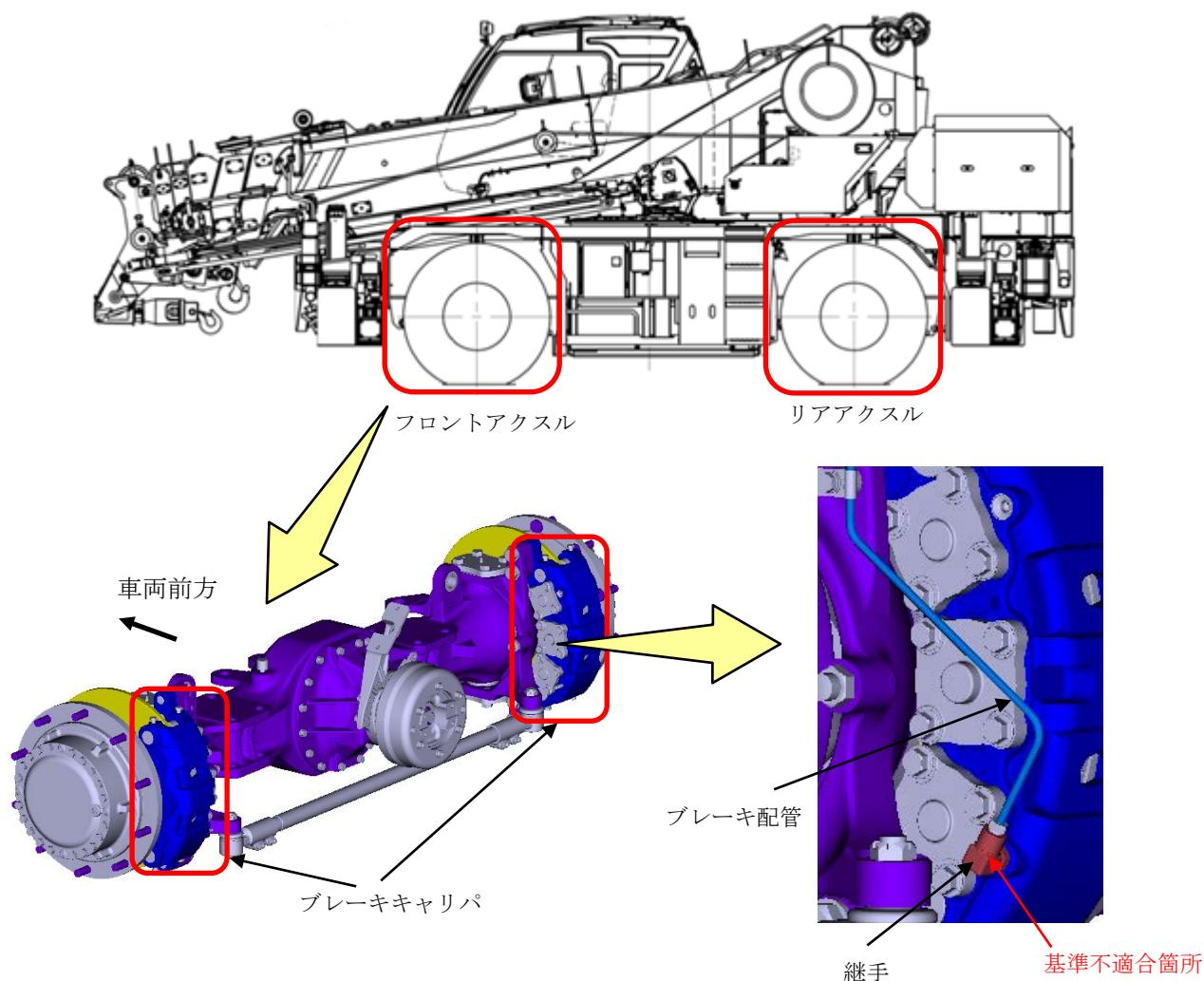
ホイール・クレーンの制動装置において、ブレーキ配管継手の寸法が不適切なため、継手のねじ込み深さが不十分な状態で締め付けたものがある。そのため、そのままの状態で使用を続けると、継手部からブレーキ液が漏れ、最悪の場合、制動力が低下するおそれがある。
