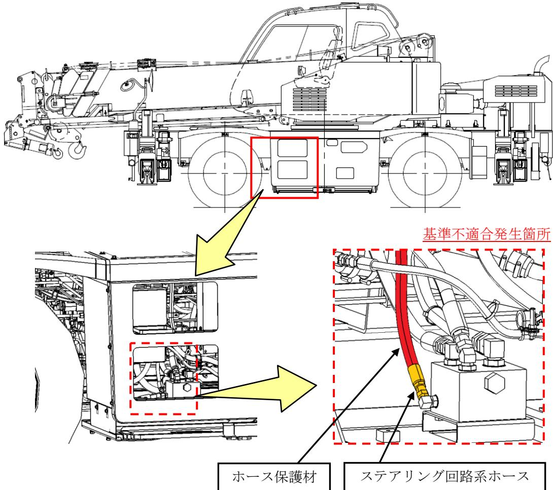
ホイール・クレーンの油圧ステアリング回路系ホースにおいて、ホース保護材の固定範囲が不適切なため、局部的な曲げ負荷が生じるおそれがある。そのため、そのままの状態で使用を続けると、繰り返し圧力によりホースが損傷し、作動油が漏れ、容易にステアリング操作ができないなくなるおそれがある。
