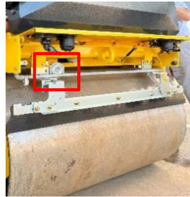
図：改善対策後の警音器 取付位置（車体の前方）
