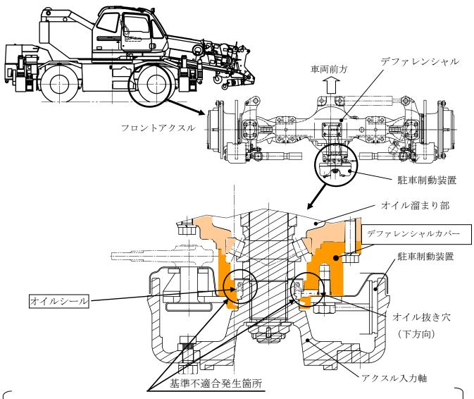
前車軸のデファレンシャル(差動装置)において、オイルシール(潤滑油用密封ゴム)の耐久性が不足しているため、摩耗が進行し、潤滑油が漏れる場合がある。そのため、そのままの状態で使用を続けるとデファレンシャルカバーのオイル抜き穴の形状が不適切なため、漏れた潤滑油が駐車制動装置の摩擦面に付着し、最悪の場合、駐車制動力が低下するおそれがある。
