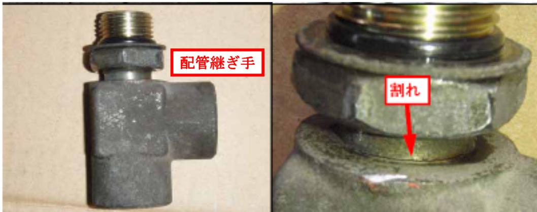
動力伝達装置の後車輪用の油圧配管において、製造時のバラツキにより配管継ぎ手の強度が不足しているものがある。そのため、そのまま使用を続けると、振動等により当該継ぎ手に亀裂が発生し、発生した亀裂から作動油が徐々に漏れるおそれがある。
