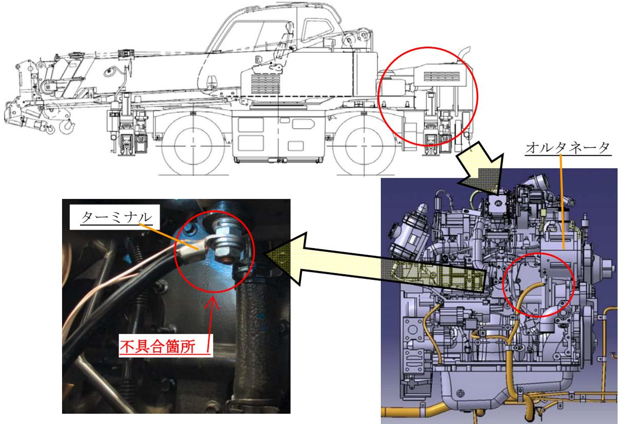
原動機のオルタネータ部の配線において、配索が不適切なものがあ、原動機の振動によりターミナル部が断線し、チャージングランプが点灯するおそれがある。なお、走行中にチャージングランプが点灯した場合でも、原動機が停止することなく、運転者は路肩移動等の対応可能である。
