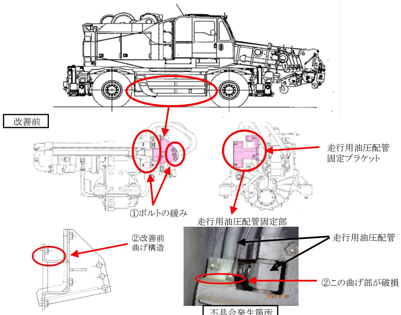
動力伝達装置の走行用油圧配管の固定ブラケットにおいて、
