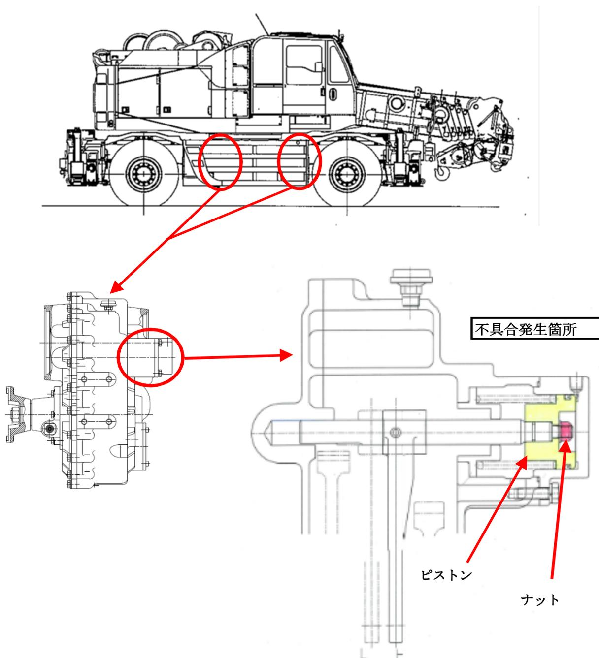
動力伝達装置の副変速機において、高低速切換をおこなうピストンを固定するナットの締付けが不適切なため、ナットが緩んで外れ、切換ができなくなるおそれがある。
