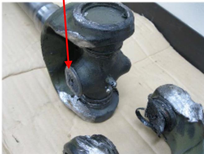
取扱説明書の2輪駆動/4輪駆動切換スイッチの説明において、4輪駆動を使用する路面の説明や注意喚起がされていない。そのため、アスファルトやコンクリートなどすべりにくい路面で4輪駆動を使用すると、センターデフ機構を持たないため、最大操舵時に前軸のクロスジョイント部に負担がかかり破損するおそれがある。なお、破損しても4輪駆動にならないこと以外は問題なく、2輪駆動における一般道の走行に影響はない。
