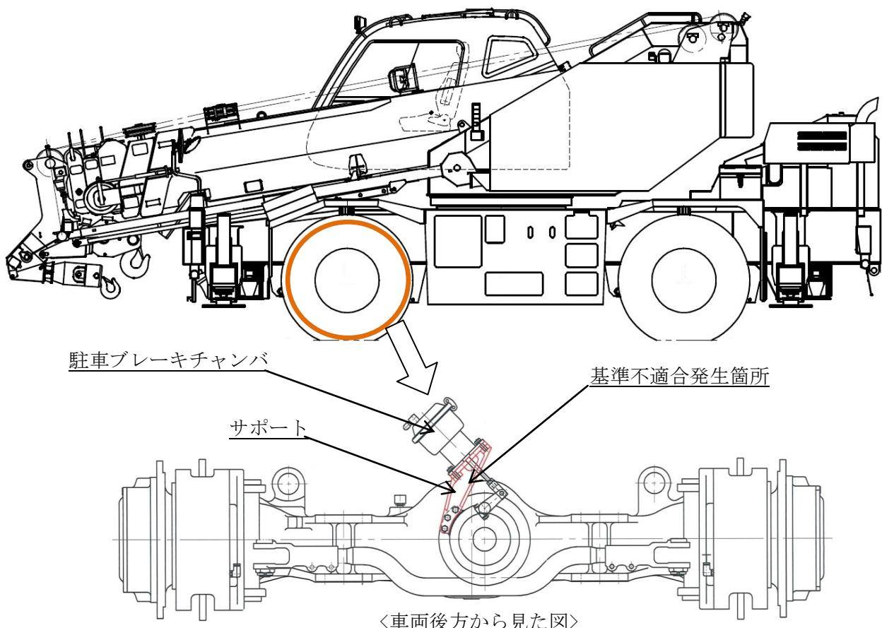
ホイールクレーンの制動装置において、駐車ブレーキチャンバのサポートの強度が不足しているため、サポートに亀裂が生じることがある。そのため、そのままの状態で使用を続けるとサポートが折損し、駐車ブレーキが効かなくなるおそれがある。
