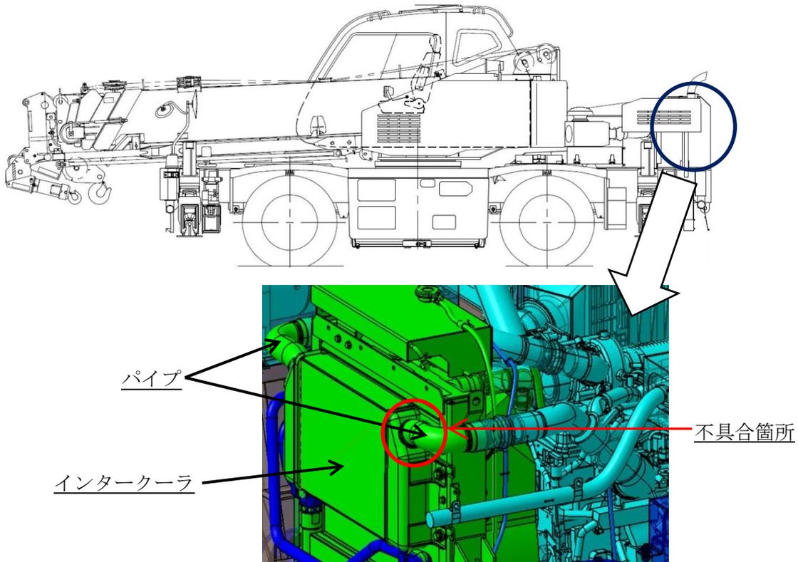
ホイールクレーンの原動機吸気装置において、インタークーラパイプの強度不足により亀裂が生じるものがある。そのため、そのままの状態で使用を続けるとパイプが破断し、エンジンの出力が低下するおそれがある。
