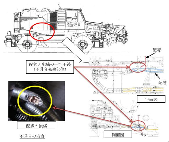
ホイール・クレーンにおいて、スターターモータの電気配線の配策設計が不適切ため、 電気配線と作動油の配管が接触し電気配線の被覆が損傷することがある。そのため、配 線と配管が接触するとスパークが発生し、配線が断線、または配管が損傷して、エンジ ンが始動できない、もしくは作動油が漏れるおそれがある。
