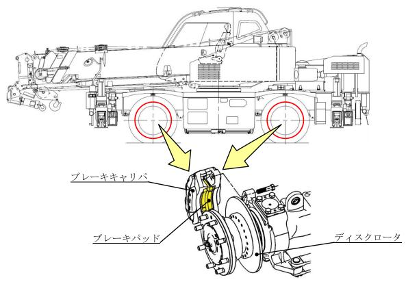
ホイール・クレーンの制動装置において、ブレーキキャリパのピストンとブレーキパッドの重心 点がずれているため、制動時にブレーキパッドとディスクロータの接触面が均一に接触しない。 そのため、ブレーキパッドおよびディスクロータが振動して音を発するおそれがある。
