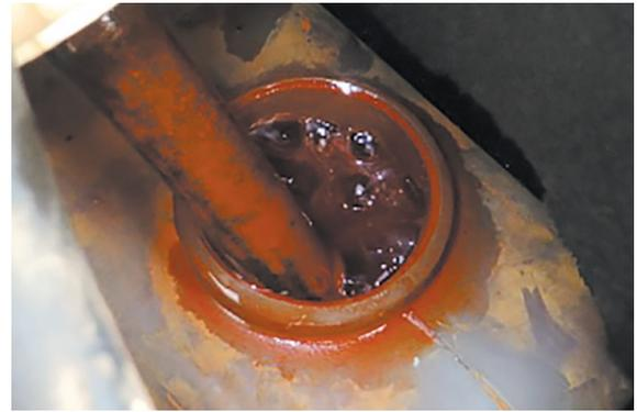
クーラントの比重が適正な場合でもクーラントの汚れがひどいと防錆性と消泡性が早期に低下する場合があります。汚れがひどい場合は継ぎ足しではなく全量を交換しましょう！
