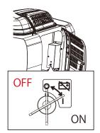
※バッテリ遮断スイッチをOFFに するときやバッテリの端子を外 すときには、キースイッチを OFFにして5分以上経過してから 実施してください。
