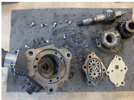
錆の発生による内部破損の例
